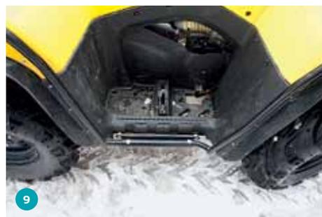
**7** На страже самого ценного. Поднятый радиатор не только меньше забивается грязью, но и закрыт от механических повреждений серьезной защитой
