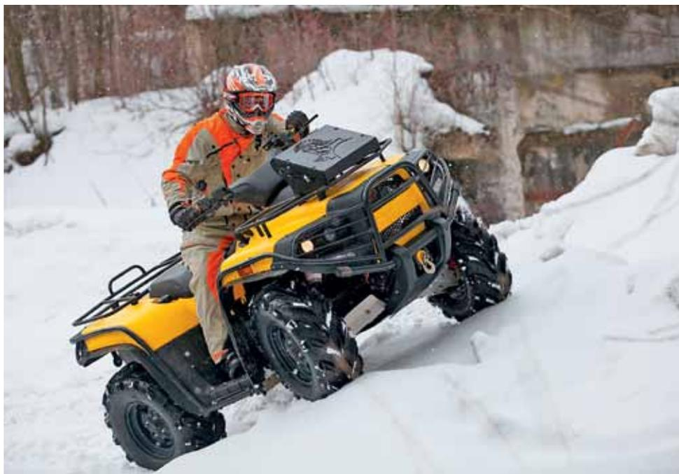
**Обороты двигателя** в режиме заднего хода искусственно придушены – своеобразная «защита от дурака». Для снятия этой блокировки используется желтая кнопка **Override** на левой рукоятке
